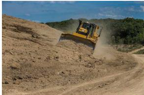
Der jüngste Cat-Kettendozer D8T mit rund 40 t Einsatzgewicht wurde konstruktiv so ausgelegt, dass er in kürzerer Zeit mehr Material als bisher bewegen kann. Die Maschine ist mit einem vollständig neuen automatischen Getriebe ausgerüstet.
